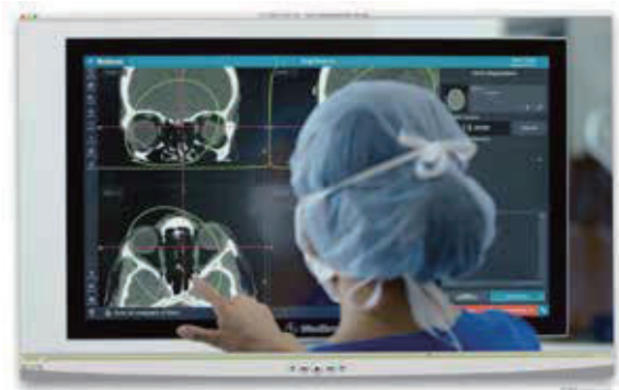
レジストレーション（手術前の位置合わせ）画面 緑の楕円内が高信頼性範囲を示している
